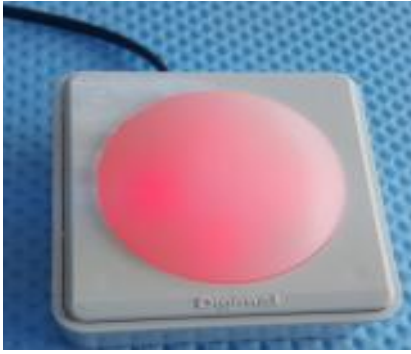
Şekil 10 : Çağrı atıldığında ikaz lambası.
