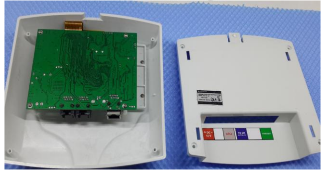
Şekil 7: Ön kapak ve arka gövde yerleştirilir.
