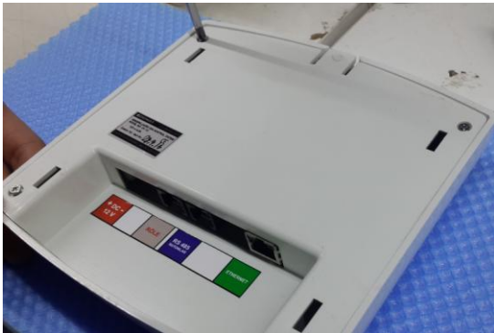
Şekil 8: Cihazın arka kapağı vidalanarak kapatılır.
