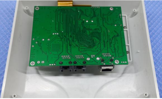
Şekil 6: PCB kartın monte edilmiş görünümü.
