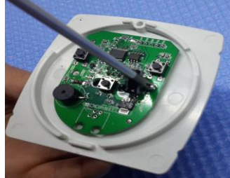
Şekil 2: PCB kartının arka kapağa montajı.
